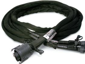
**Выходные удлинительные кабели** обеспечивают удаление источника питания от детали на расстояние до 50 футов (15 м). Изолированные быстроразъёмные соединения служат для лёгкого отсоединения и подключения шлангов подвода охлаждающей жидкости. Разъём источника питания надёжно фиксирует соединение кабеля к аппарату и
